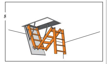
UNFOLDING DOWN THE LADDER.
