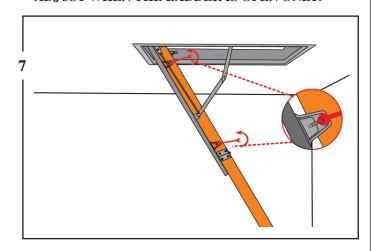
ADJUST OUTWARDS TO INCREASE CLEARANCE BETWEEN LADDER & HATCH DOOR.
